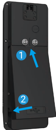
Instalación de la batería
